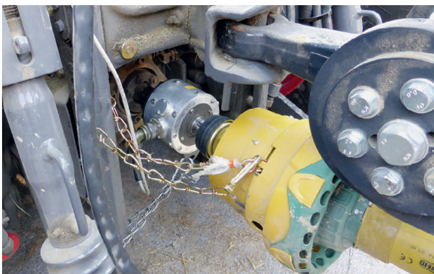
Bild 9: Walterscheid 2,5 kNm Messnabe an der Heckzapfwelle
